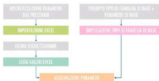
Figura B2 - Compilazione massiva dei parametri del modello a partire dalle Chiavi del prezzo e dai valori associati: pipeline tabella sorgente → script Dynamo → scrittura su tipi/istanze con tracciabilità di versione di script e dataset.
