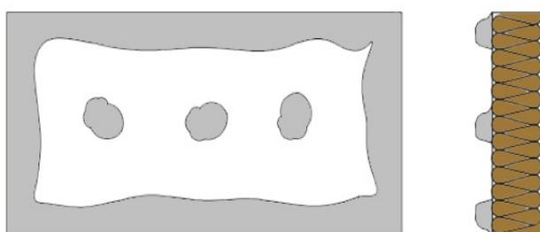
Realizzazione di un bordo di colla (cordolo) e due o tre punti di incollaggio al centro del pannello in modo che premendo il pannello isolante sul fondo e rispettando le tolleranze ammissibili per il supporto si abbia una copertura minima di collante del 40%.
