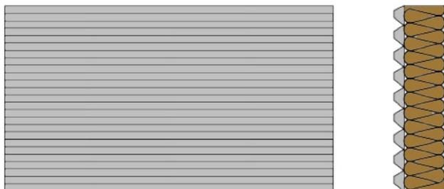
La colla **viene** applicata sul pannello isolante con spatola dentata (con dentatura variabile in base alla regolarità del supporto).
